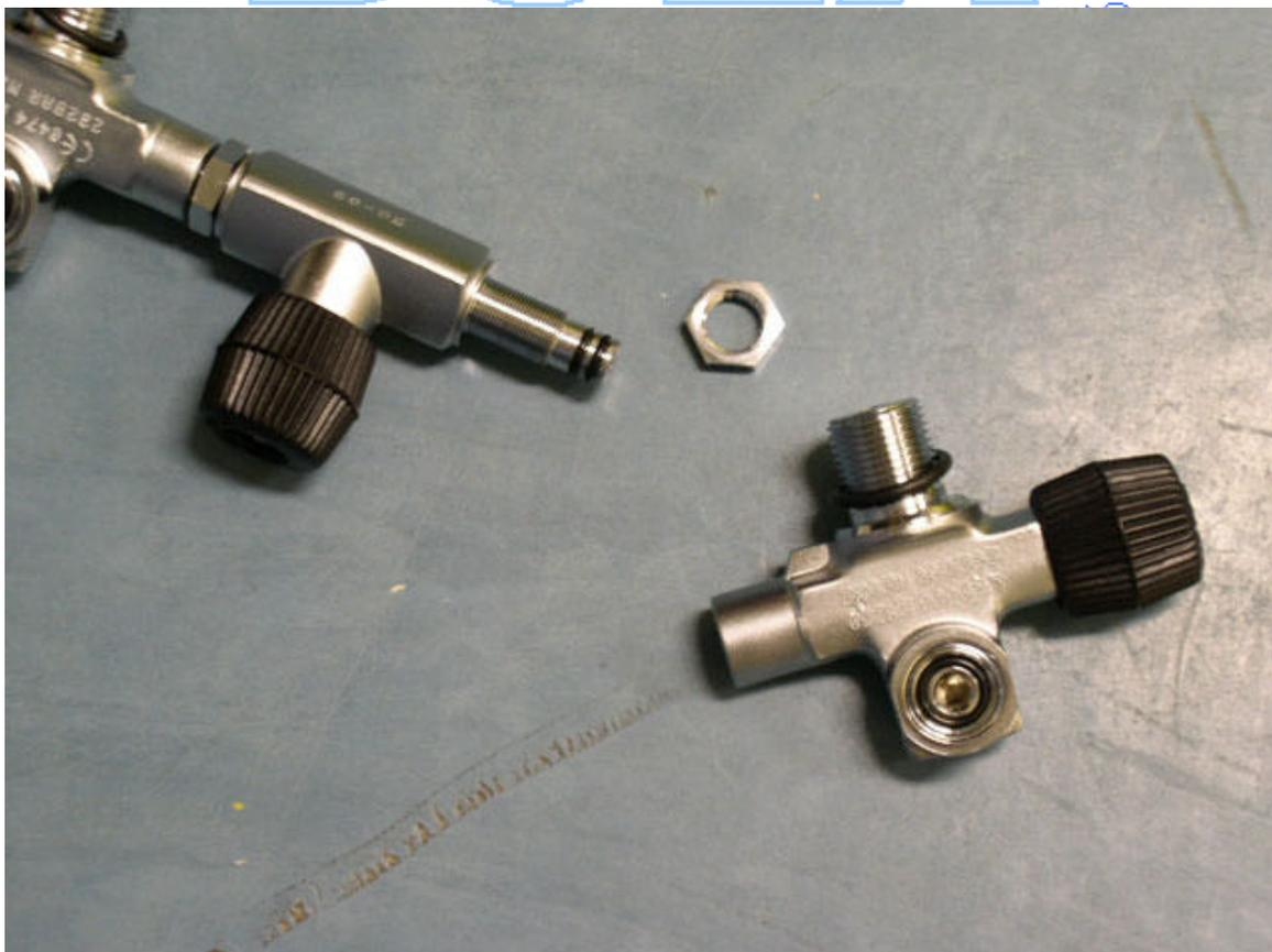
Es un buen momento para revisar el interior de las botellas y el desmontaje anual asegura que no quedarán las griferías soldadas por electrolisis a las botellas de aluminio. Apretamos con la mano las griferías (no es preciso martillarlas ni usar llaves de grifa). Podemos sustituir la junta de 25 por otra de 24 de dureza Shore 80 u 85.
